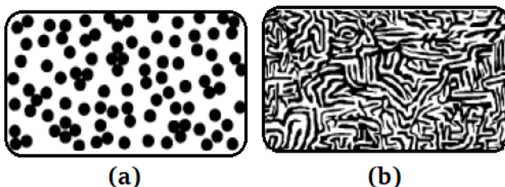
Figure III.4 : Schématisation des morphologies obtenues par (a) la 1ère voie : morphologie particules-matrices comportant des agrégats et (b) par la 2nd voie : morphologie co-continue à l'échelle moléculaire [Hajji, 1999]
