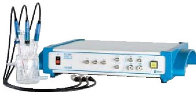
Figure II. 17. Dispositif expérimental (la cellule et le Voltalab).
