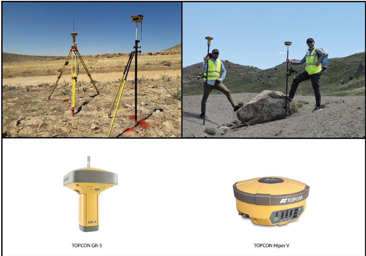
Fig.36. Le matériel de terrain utilisé : les récepteurs GNSS bi-fréquence.
