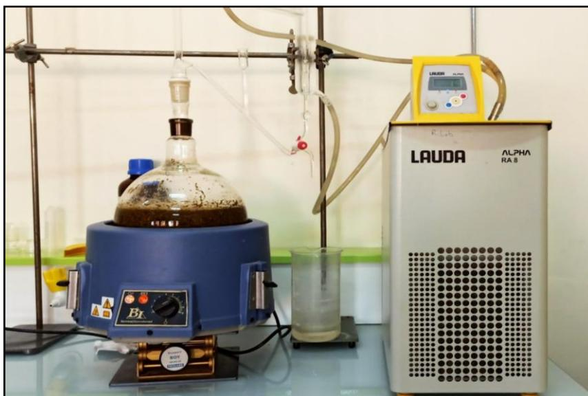
**Figure 10** : Extraction des huiles essentielles par hydrodistillation (Dispositif de type clevenger)
