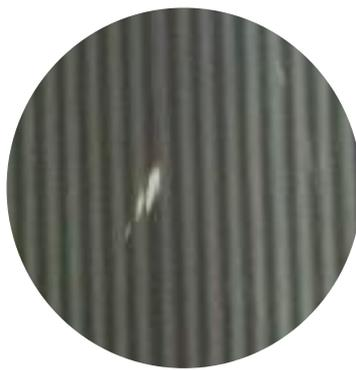
**Figure 2.13.** Franges de moiré sont observées en mode d'éclairage incohérent [46]
