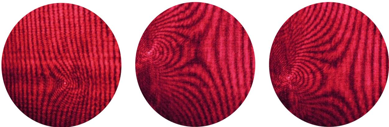
**Figure 4.39.** Inspection d'une lame de Plexiglass après avoir créé le défaut
