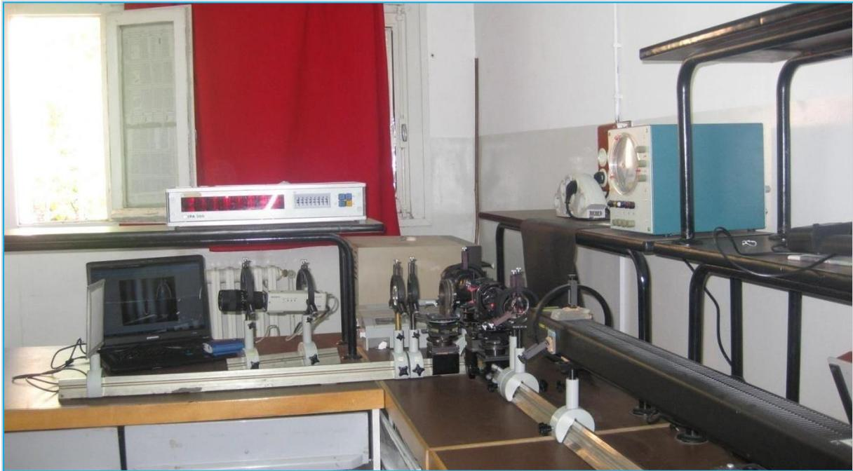
**Figure 4.3.** Montage expérimental pour la topographie des surfaces réfléchissantes
