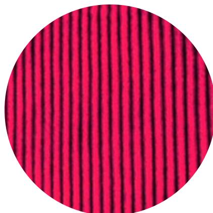
**Figure 4.5.** Figure de moiré du miroir optique plan
