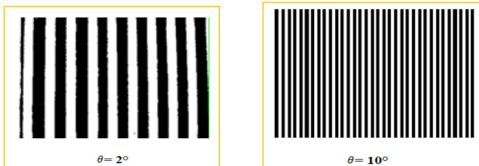
**Figure 2.26.** Franges de moiré pour différents angles d'inclinaison
