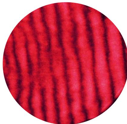
**Figure 4.35.** Franges de moiré de la plaque de verre de mauvais état de surface avant création de défaut
