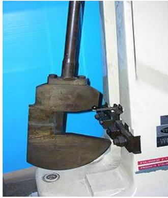
**Figure III. 8 :** Gros plan sur le couteau et la porte éprouvette d'un mouton Charpy
