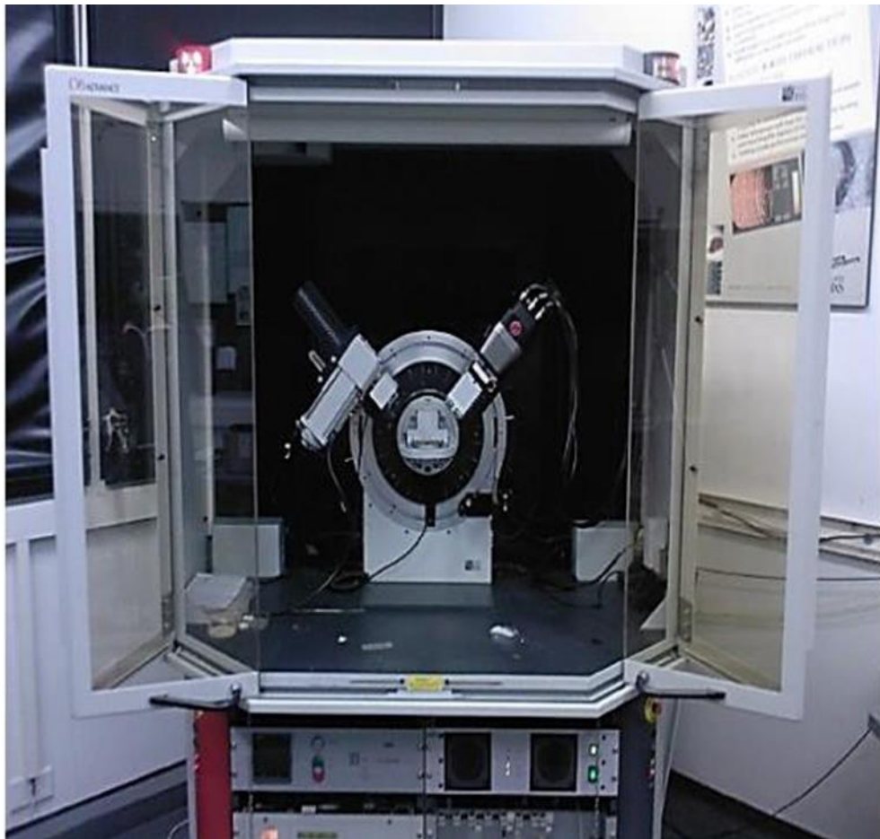
Figure II.10 : Représentation d'un diffractomètre des rayons X Philips X'Pert, utilisé pour l'étude structurale.
