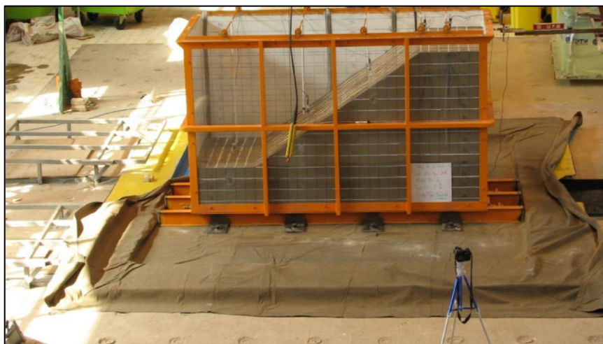
Figure 3.48 : Modèle et dispositif de table vibrante, Jahromi et al. (2018).
