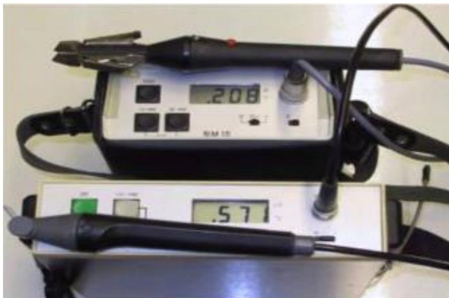
**Figure 2.2** Conductimètre à sonde mobile
