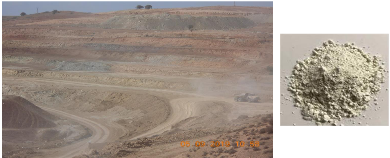
Figure III. 2 Représentation de la montmorillonite naturelle extraite du gisement de Roussel [10].
