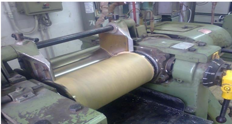
Figure III. 6 Élaboration des nanocomposites PVC/MMT à l'aide d'un mélangeur à deux cylindres.
