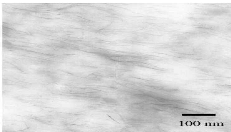
Figure I. 28 Image MET de nanocomposite exfolié PA6/argile modifiée (5% en masse) [14].
