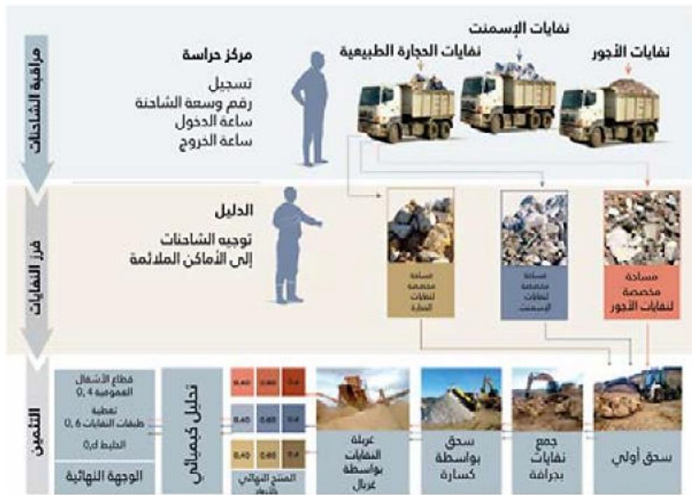
الشكل رقم 2.4 : مراحل تثمين النفايات في مركز النفايات الهامدة بحميسي
