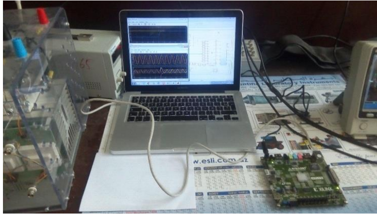
Figure III.9. Configuration expérimentale sur une carte Xilinx Atlys Spartan-6.
