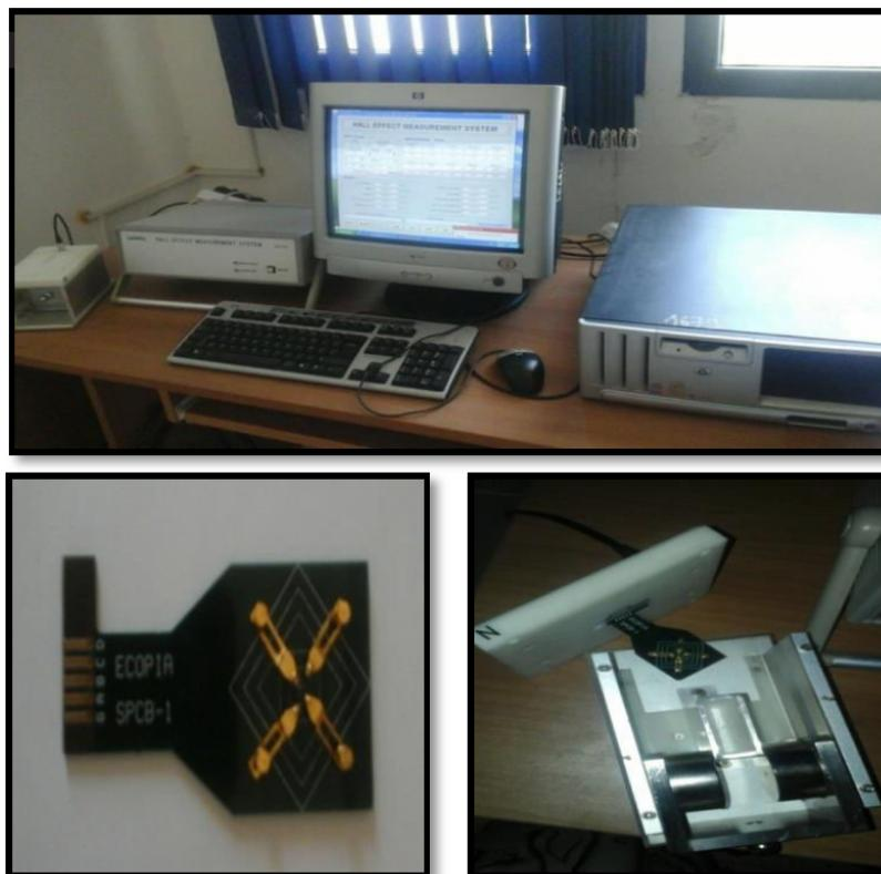
**Figure II. 25.** Dispositif des mesures électriques par effet Hall HMS 3000.
