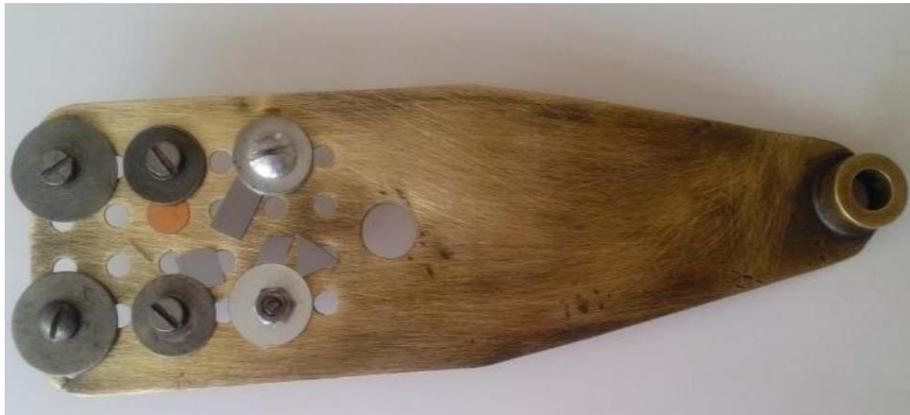
Figure II. 5. L'emplacement des différents substrats sur le porte-substrat.
