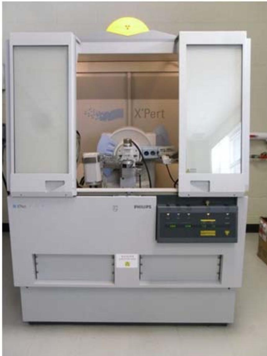
**Figure II. 17.** Photo du Diffractomètre X' Pert Pro de Philips du CRNA.
