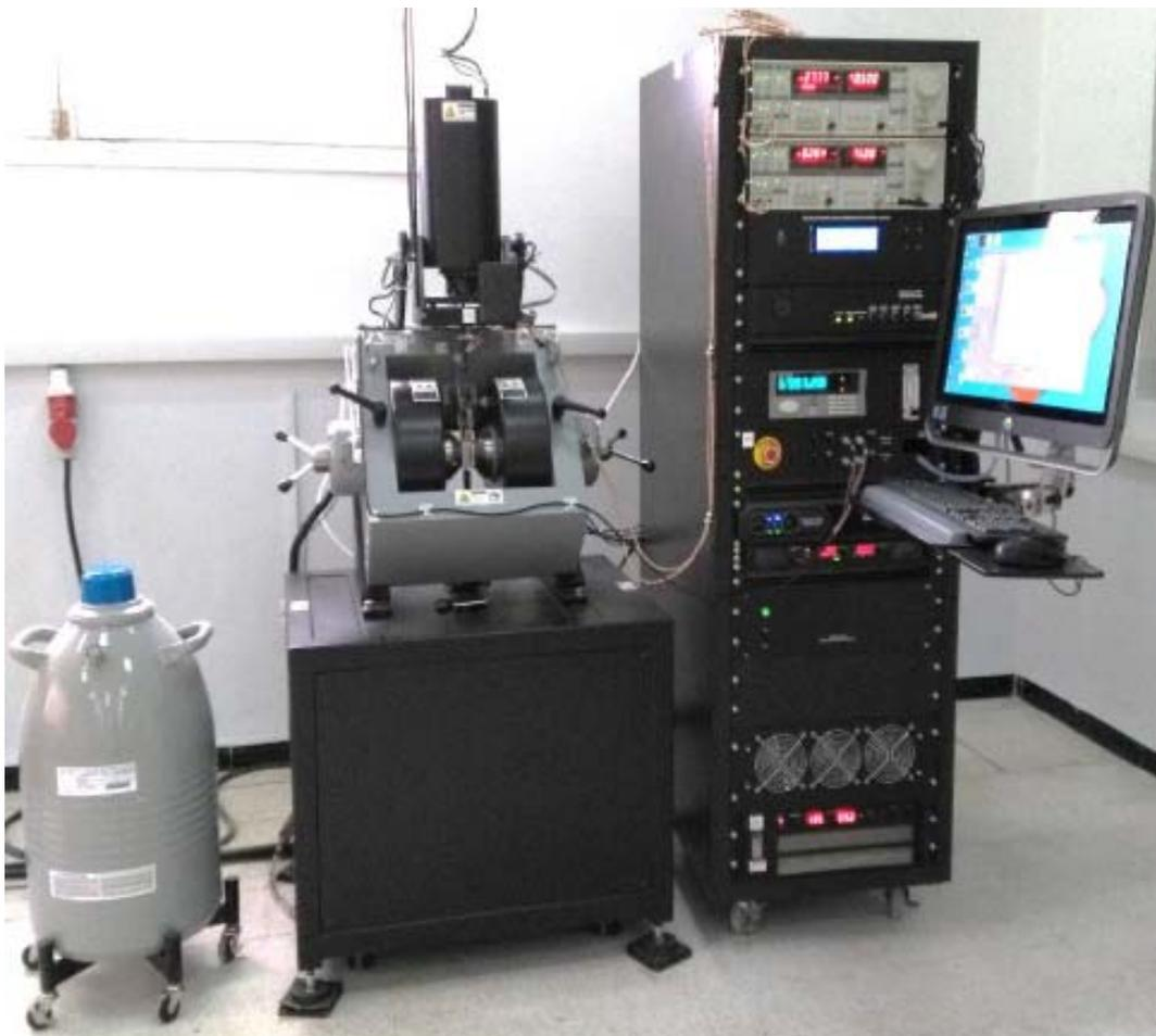
*Figure II. 20* Magnétomètre à échantillon vibrant (VSM).
