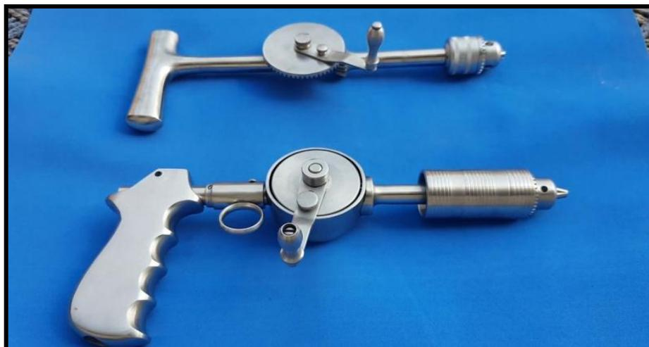
**Figure 28 :** Perceuses manuelles dotées d'un mandrin.
