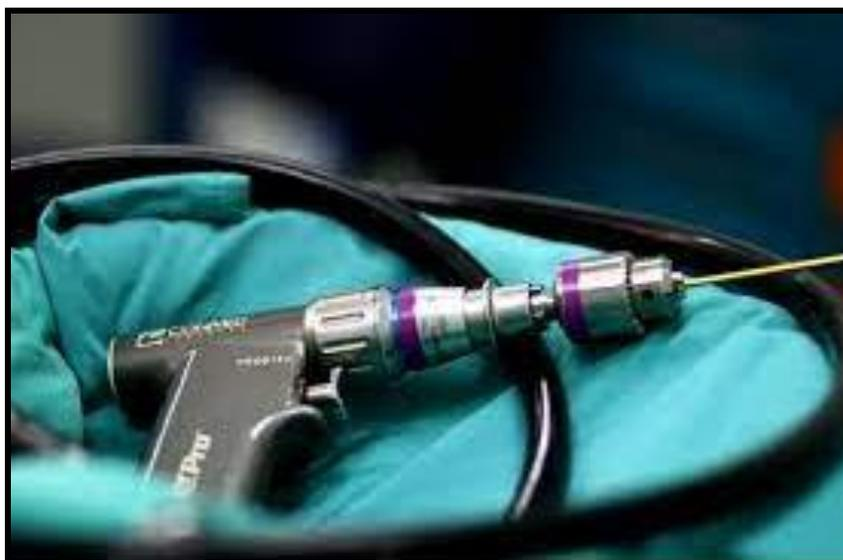
**Figure 32 :** Perceuse pneumatique avec mandrin.
