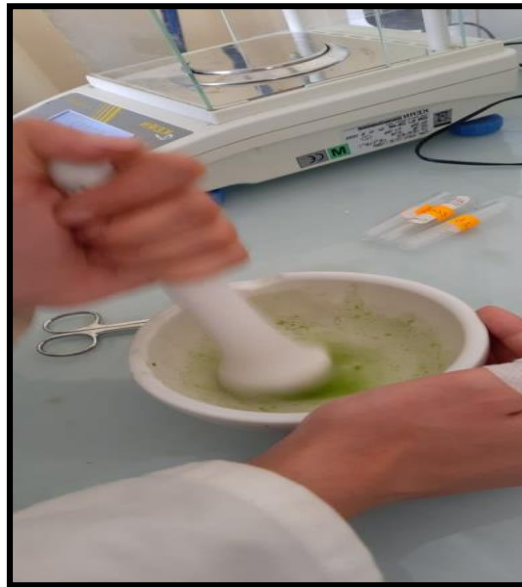
Figure 23 : extraction de la chlorophylle à l'aide de l'acétone 80%.
