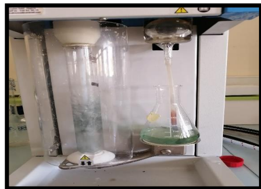
Figure 19 : détermination de la teneur en azote par la méthode de Kjeldahl. (Source auteur)
