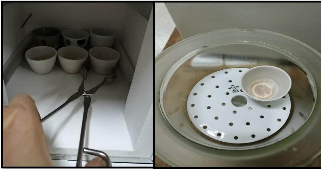
Figure 18 : détermination de la teneur en matières minérales totales (cendres) à l'aide de la méthode d'incinération au four à moufle. (Source auteur)
