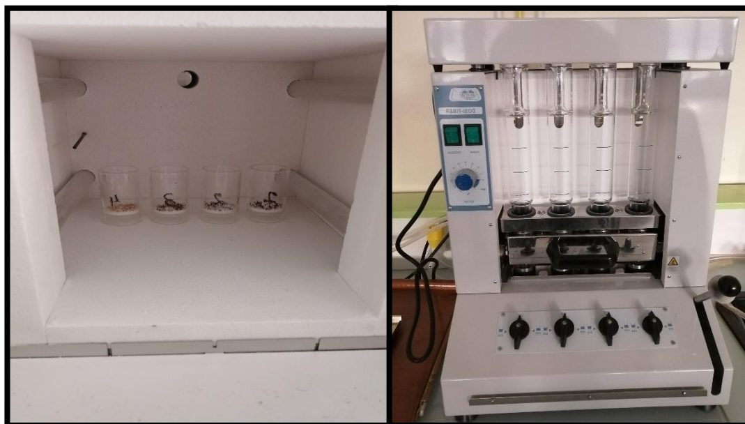
Figure 20 : La détermination des fibres brutes à l'aide du fibertec. (Source auteur).
