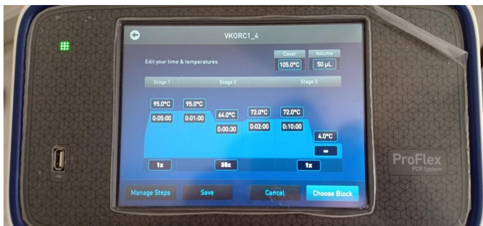
Figure 24: Thermocycleur « ProFlex PCR System » utilisé dans le génotypage.
