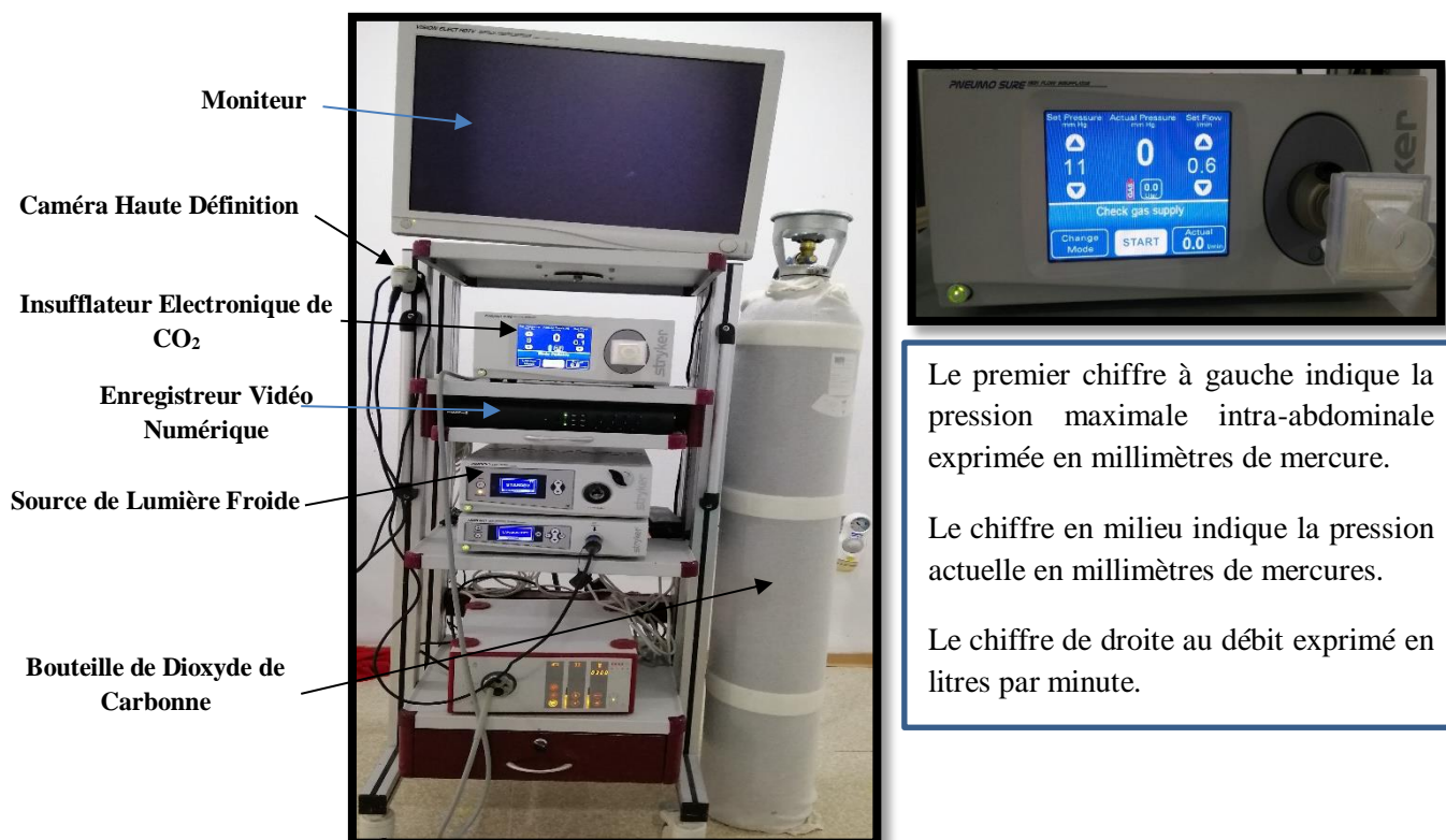
Figure 28 : Colonne de cœlioscopie et Insufflateur du service de chirurgie de l'enfant et l'adolescent CHU de Sétif
