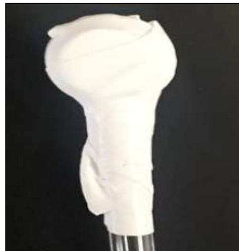
Figure 3.9 (a) Le VSM utilisé dans cette étude pour collecter des cycles d'hystérésis d'échantillons. (b) Une disposition schématique du VSM. (c) Un échantillon et le porte-échantillon utilisés pour préparer les échantillons à collecter dans le VSM. (d) Un échantillon préparé sur un porte-échantillon et enveloppé dans un film de Teflon.
