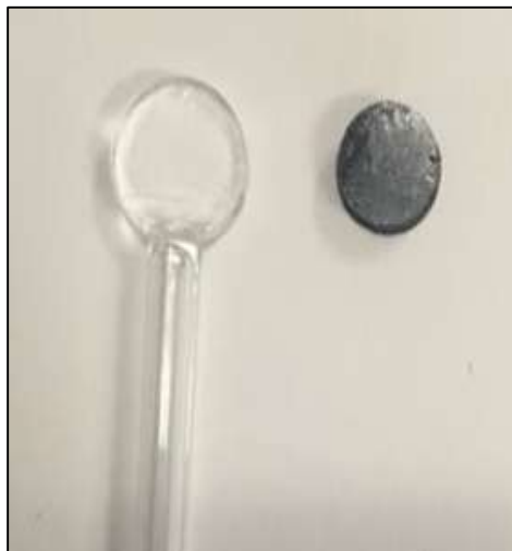
Figure 3.9 (a) Le VSM utilisé dans cette étude pour collecter des cycles d'hystérésis d'échantillons. (b) Une disposition schématique du VSM. (c) Un échantillon et le porte-échantillon utilisés pour préparer les échantillons à collecter dans le VSM. (d) Un échantillon préparé sur un porte-échantillon et enveloppé dans un film de Teflon.
