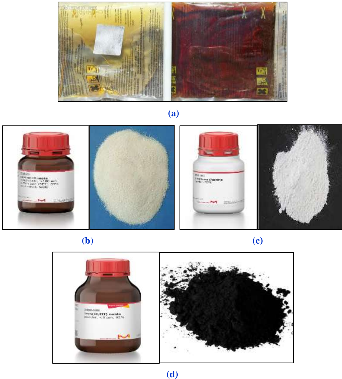
Figure 3.10 Les différents matériaux utilisés dans la composition des composites ternaires : (a) La résine époxyde. (b) Titanate de Calcium. (c) Titanate de Strontium. (d) Oxyde de fer noir.
