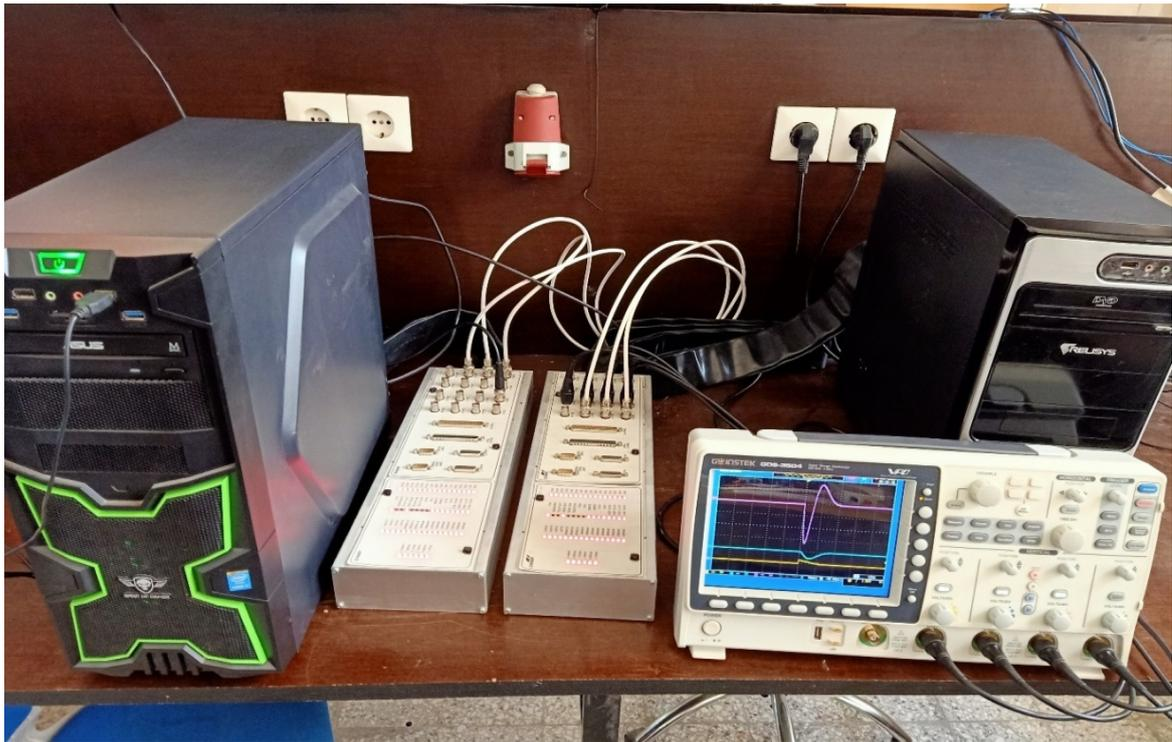
Figure 3. 12 Hardware-in-the-loop (HIL) Simulink temps réel pour le système de torche à plasma
