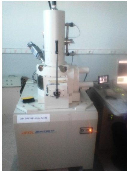
Figure IV.15 : Microscope électronique à balayage utilisé.
