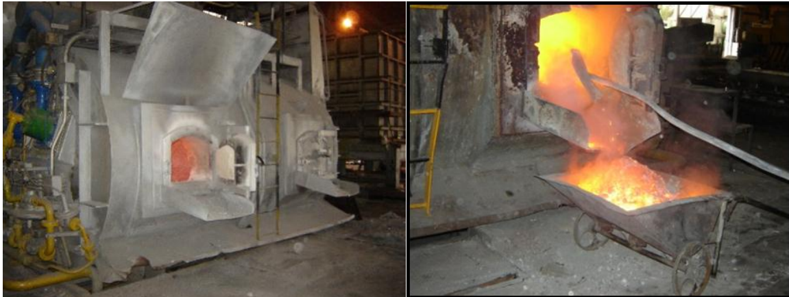
Figure I.3 : Four de fusion de l'aluminium en plein air et extraction des scories.
