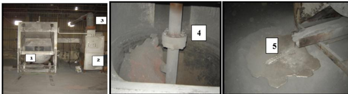
Figure I.4 : Séparation des scories d'aluminium de l'aluminium métallique.
