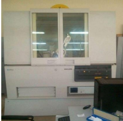
Figure IV.10 : Diffractomètre des rayons X utilisé.
