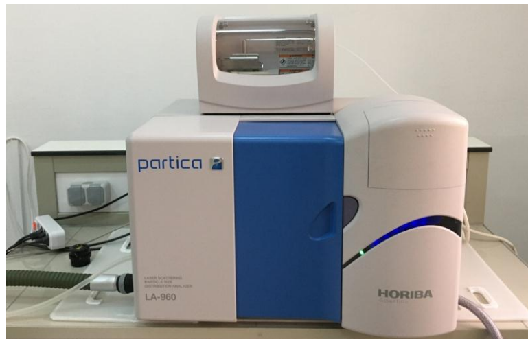
Figure IV.11 : Granulomètre laser utilisé.
