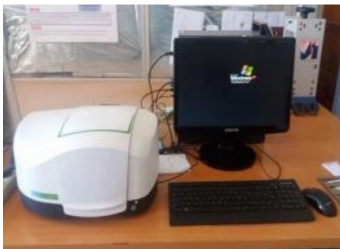
Figure IV.12 : Spectromètre FTIR utilisé.
