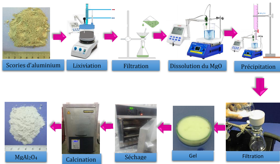
Figure IV.8 : Protocole suivi pour la synthèse du spinelle ( \text{MgAl}_2\text{O}_4 ).
