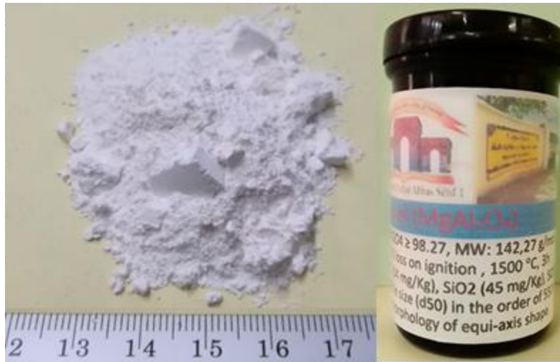
Figure IV.17 : Poudre de spinelle ( MgAl_2O_4 ) synthétisée.
