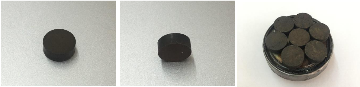
Figure IV-16 : Pastilles finies d'alumine après compactage et cuisson.
