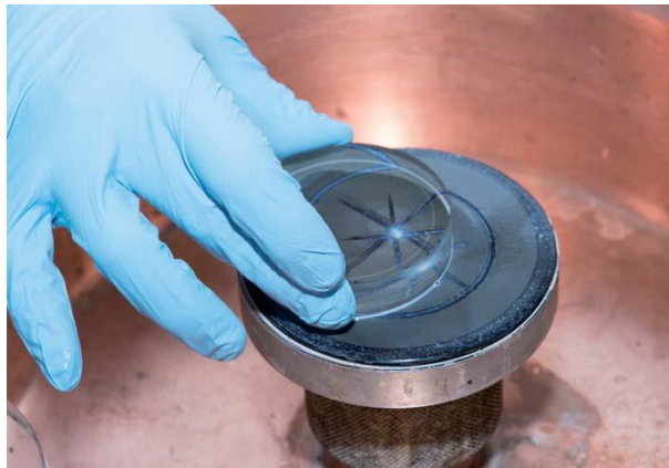
Figure II-2 : Processus de polissage avec support en poix [Beur2014].
