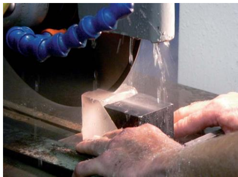
Figure II-1 : Découpage du verre optique [Beur2014].
