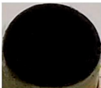
Figure (III.15) : Image du film composite de (PAni+CdTe) déposé sur l'acier doux XC70 après 24 mois.
