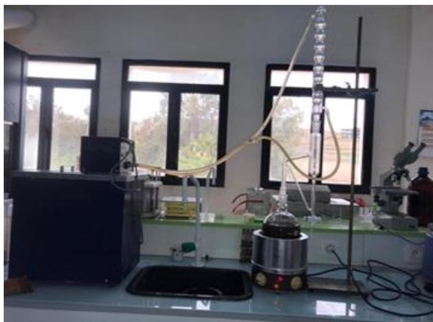
**Figure 16.** Montage de l'hydro distillateur de type Clevenger (photo personnelle).
