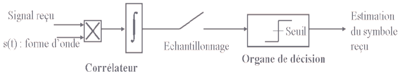
Figure 0-18: Principe de la démodulation numérique
