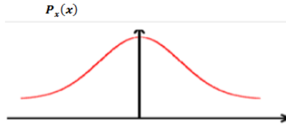
Figure 0-22: Densité de probabilité pour un canal gaussien.
