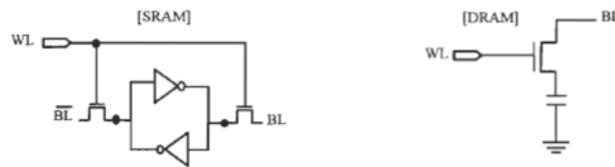
Figure 3-7 Exemple d'une mémoire RAM statique et dynamique [35]
