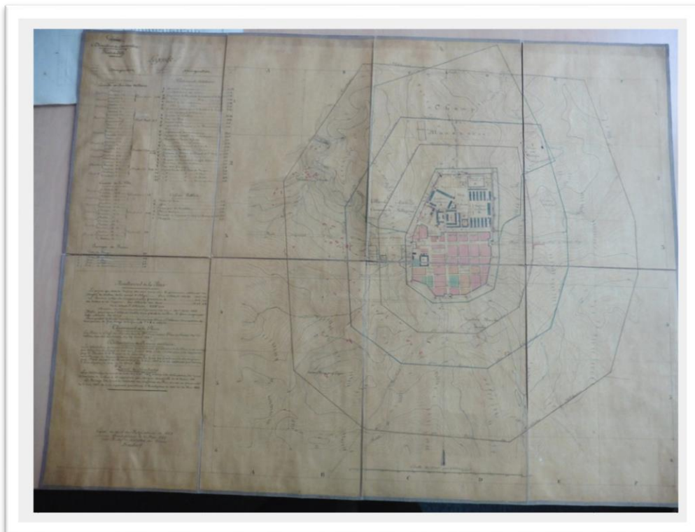
Figure 39 : Plan de 1855 établi sur la base du plan de 1847, agrandissement de la ville vers l'Est. Plan entouré de quatre couronnes de servitude (zone non aedificandi). Source : SHD. Réf. 1H/910/1.
