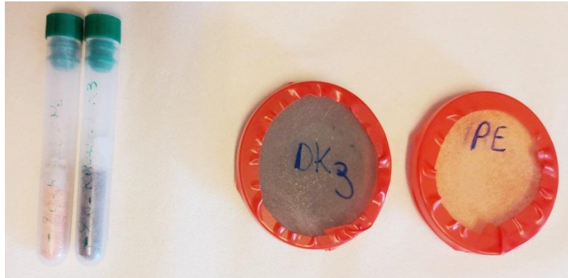
Figure 4.5 : Tubes et boîtes de Pétri utilisés pour les mesures gamma.
