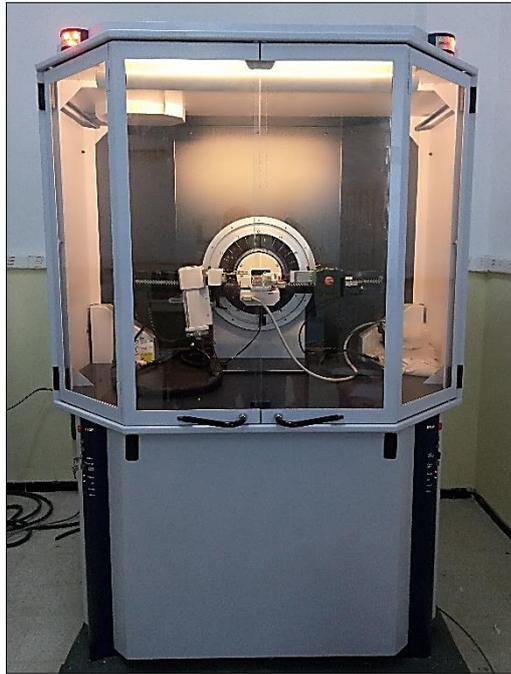
Fig. II. 23 : Diffractomètre Bruker D8 utilisé.
