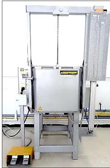
Figure II. 5 : Four à parois métalliques utilisé pour l'opération du recuit.
