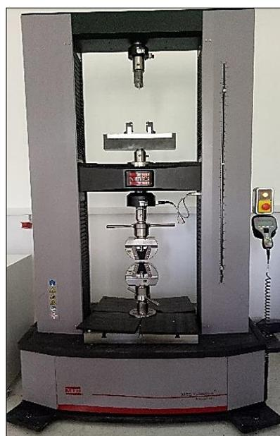
Fig. II. 18 : Machine des essais mécaniques.
