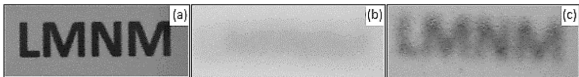
Fig. I. 18 : Transparence des échantillons en verre : (a) non traité, (b) érodé par sablage, (c) traité chimiquement par HF pendant 8h [60].
