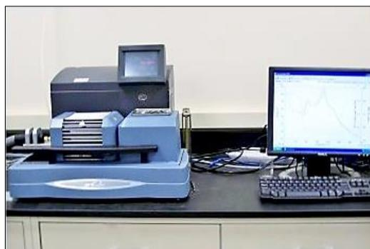
Fig. II. 15 : Équipement d'analyse thermique de type SDT Q600.
