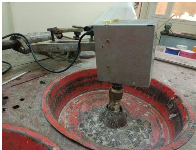
Fig. 5: Dispositif de polissage à mouvement vibratoire intégré à une polisseuse classique
