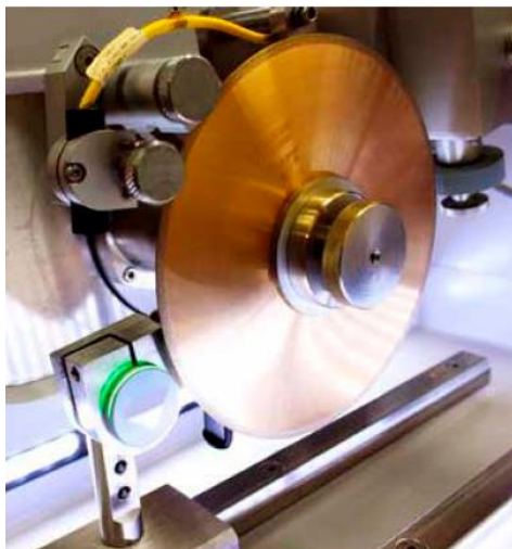
Fig. 1: Principe du tronçonnage du verre par disque diamanté[22]
