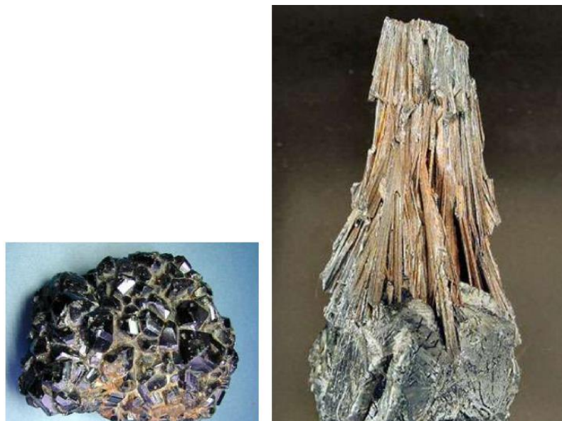
Fig. 3:Forme minérale de SnO 2 (cassitérite) [47]
