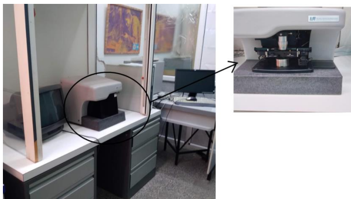
Fig. 9: Le microscope à force atomique [AFM] utilisé
