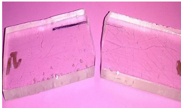
Figure 4.8 : Ruines d'impact Izod du polystyrène
