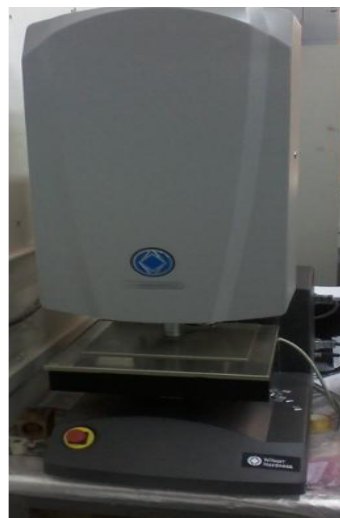
Figure 3.6 : Duromètre de type TUKON 2500 WILSON HARDNESS
