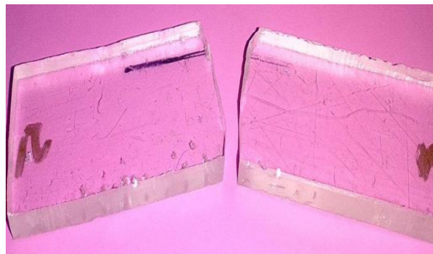
Figure 3.7 : Éprouvette rompue après l'essai de résilience
