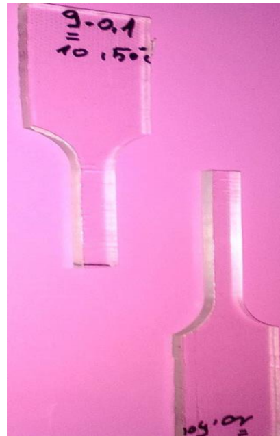
b – Echantillon après rupture
