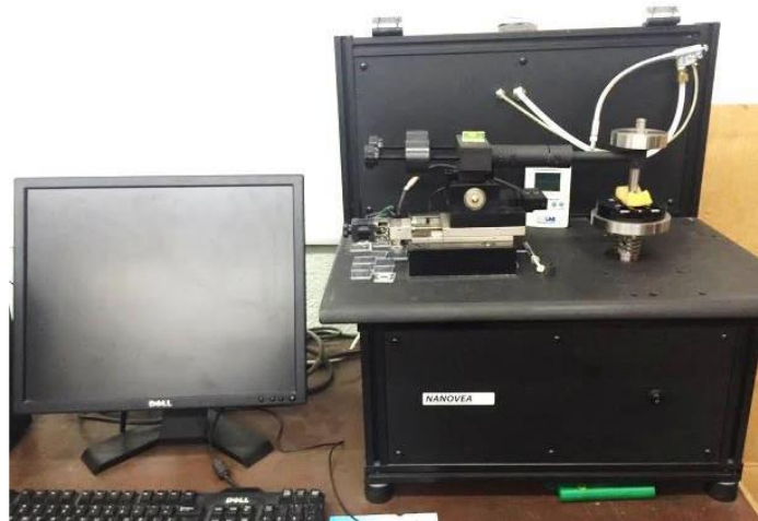
Figure 3.12 : Tribomètre type Nanovea de configuration pion disque.
