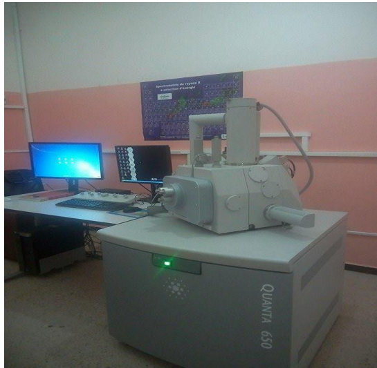
Figure 3.16 : Microscope à balayage électronique QUANTA 650
