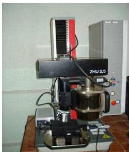
Figure 3.5 : Duromètre de type Zwick ZHU2.5
