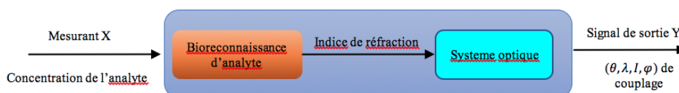
FIGURE 3.2 – Conception d'un biocapteur à résonance de plasmon de surface.
