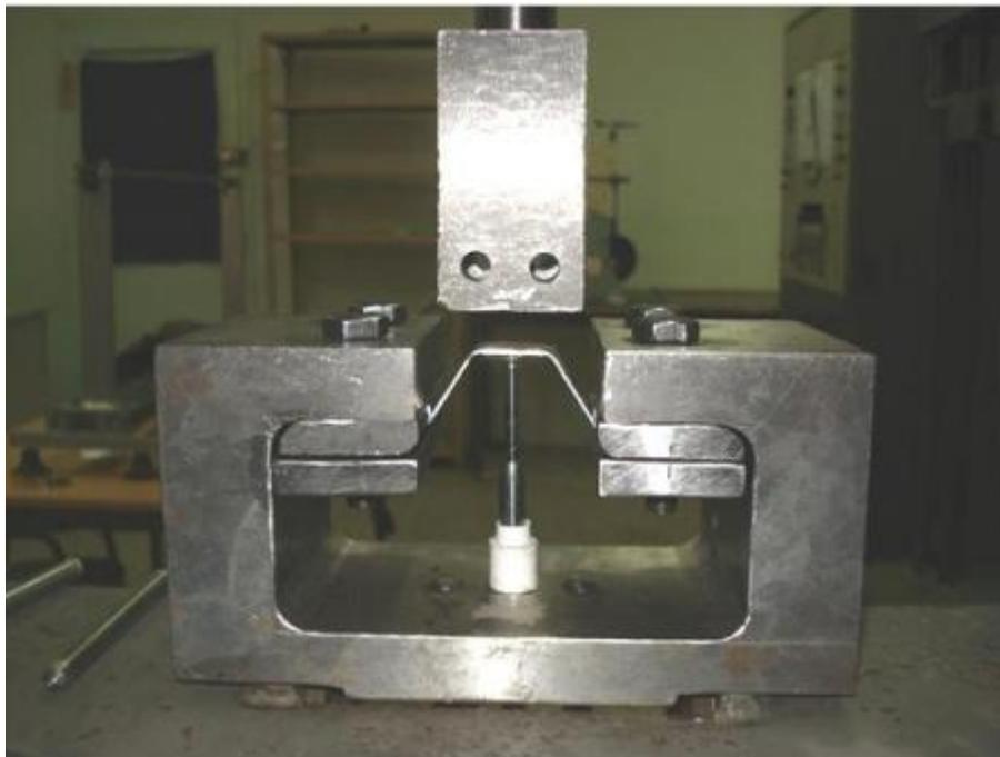
**Figure 4. 7.** Dispositif d'étirage-pliage en U adapté sur la machine de traction
