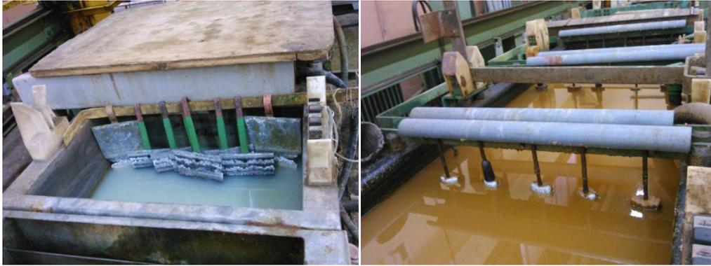
**Figure 4. 3.** Le processus d'électrodéposition.
