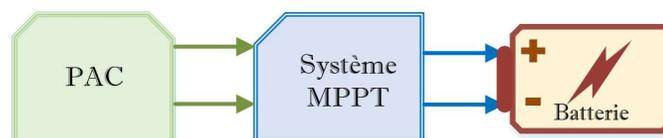
Figure 3-15 : Application de MPPT dans la charge d'une batterie
