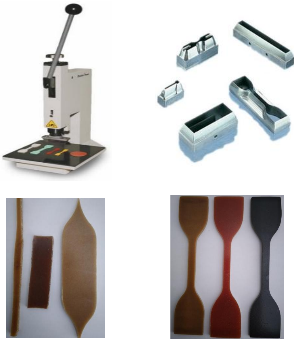
Figure III.6. Procédé de mise en forme des échantillons
