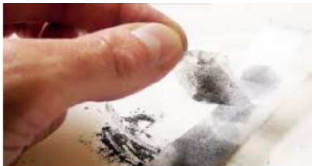
Figure 1.7. Clivage micromécanique du graphite [30]
