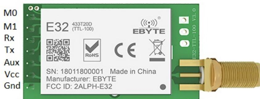
FIGURE 3.3 – Module émetteur-récepteur sans fil LoRa E32-433T20D.
