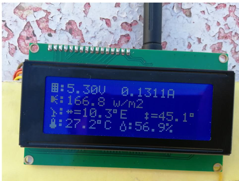
FIGURE 4.8 – Affichage du système de surveillance mobile LoRa.
