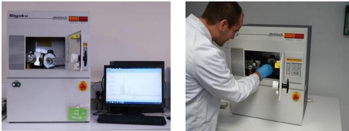
Figure II.11. Image de l'appareil du DRX
