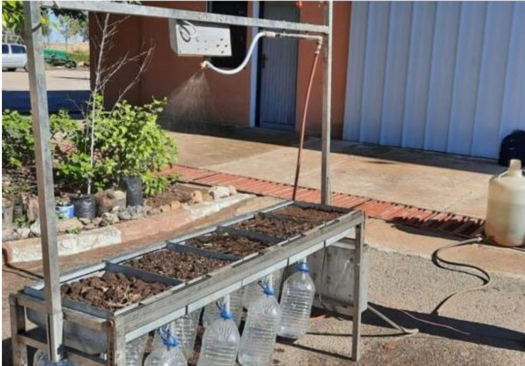
Figure I.10 : simulateur de pluie
