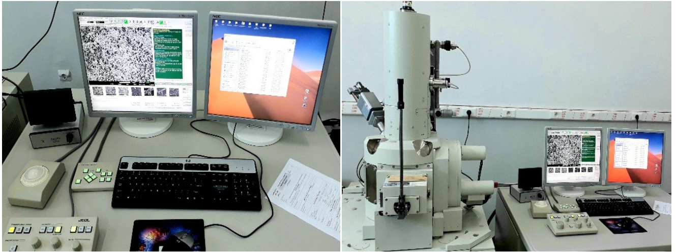
Figure II.12 Image de Micrographies au microscope électronique à balayage à émission de Champ (FESEM, JEOL, JSM-6701F).
