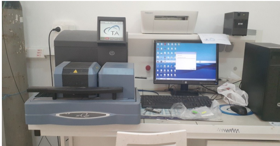
Figure II.10 : Dispositif utilisé en thermogravimétrie (ATG)
