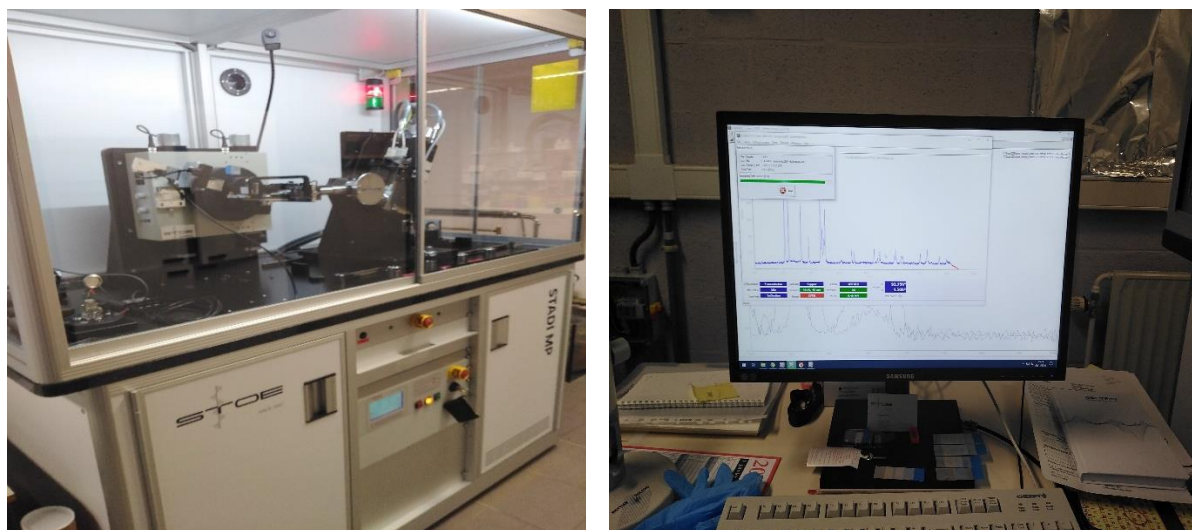
Figure II.2 : Diffractomètre de type STOE STADi mp, (Université de Namur).
