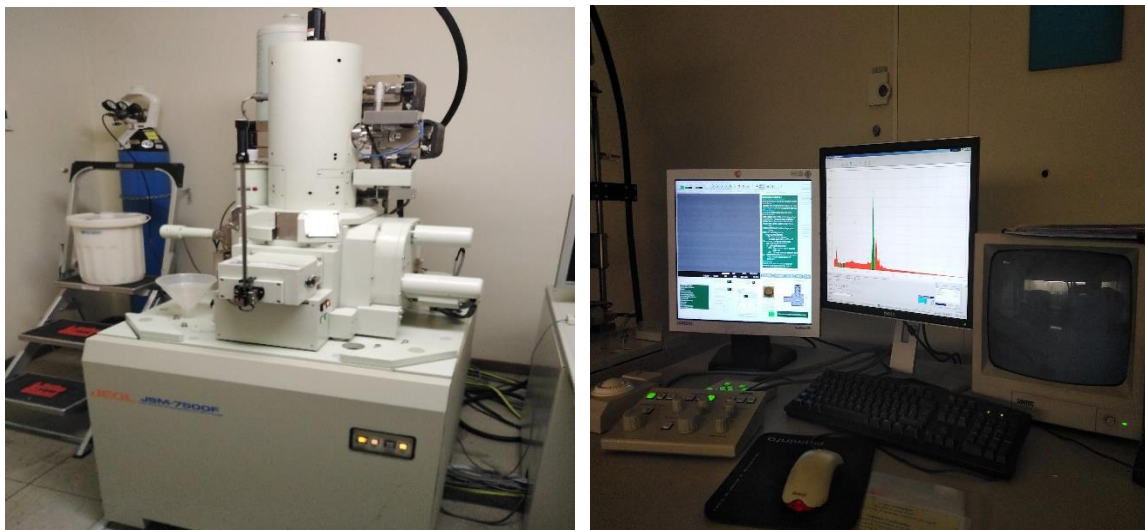
Figure II.3 : Microscopie électronique à balayage MEB couplé avec analyseur EDX (Université de Namur).
