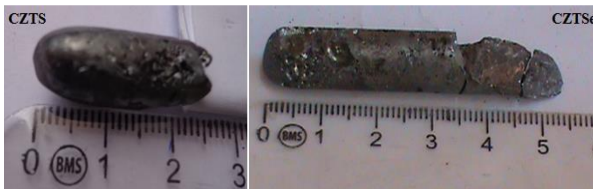
Figure III.6: Lingots de CZTS et CZTSe synthétisés.
