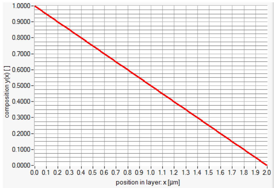
Figure IV.8: Profil de la couche absorbante à composition graduelle.
