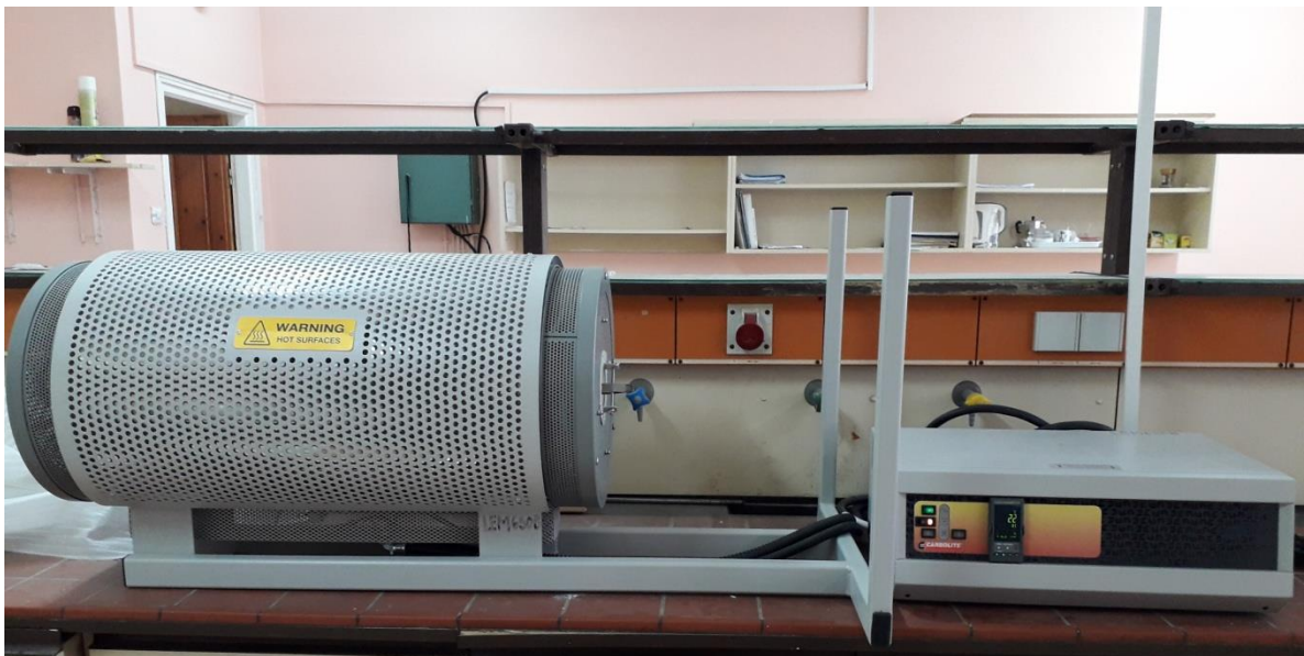
Figure II.8: Image du four tubulaire CARBOLITE utilisé pour l'élaboration des cristaux CZTS et CZTSe.
