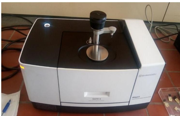
**Figure II. 9:** Image Spectromètre Infrarouge FTIR SHIMADZU QUATR-S.
