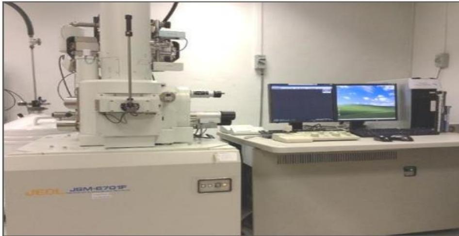
**Figure II. 13:** Image de Micrographies au microscope électronique à balayage à émission de champ (FESEM, JEOL, JSM-6701F).
