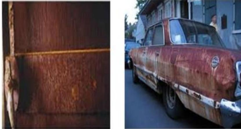
**Figure I.7:** Corrosion généralisée : exemple d'une porte et d'un véhicule corrodés [90].
