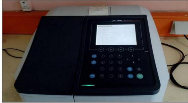
**Figure II. 11:** Spectrophotomètre double faisceau Shimadzu UV-1800.
