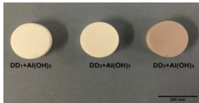
Figure IV.13 : Aspect des pastilles après pressage.
