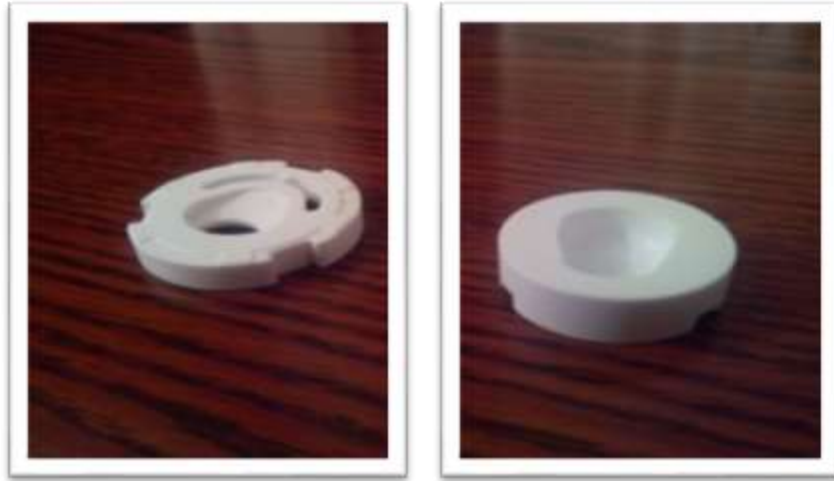
Figure V.14 : Pastilles commerciales en céramique étudiées.
