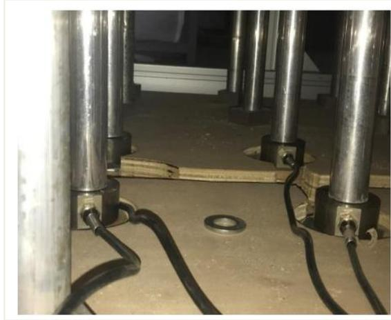
**Figure 2.6** Les capteurs de force
