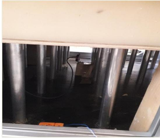
**Figure 2.8** Le capteur de déplacement
