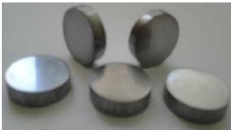
Figure IV.2. Pièces d'acier au carbone XC48 utilisées au cours des essais gravimétriques
