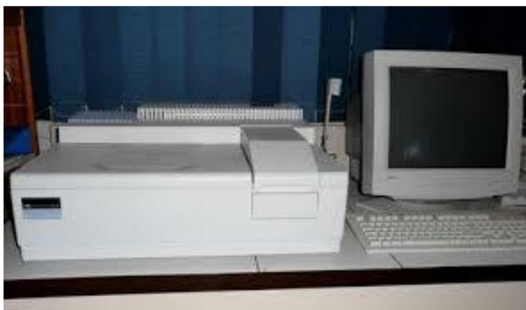
**Figure II.3.** Spectrophotomètre UV/visible.
