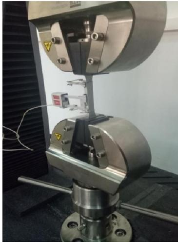
**Figure 2. 7:** Une éprouvette sollicitée à un essai de traction,
