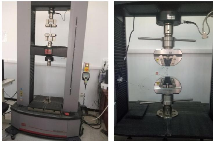
**Figure 2. 5:** Machine universelle d'essai mécanique de type MTS de capacité 100KN,
