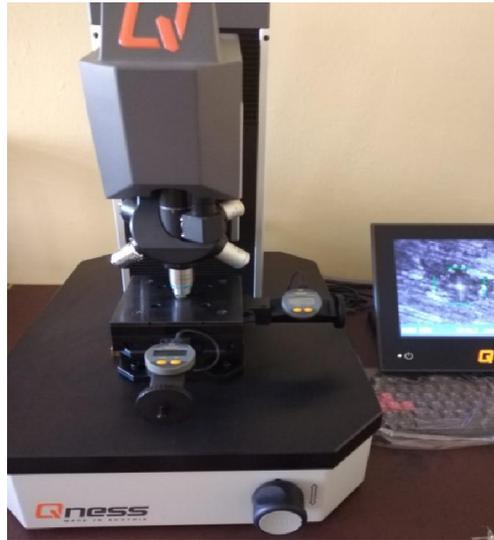
**Figure 2. 3:** Appareil d'essai de dureté Qness 402MVD,
