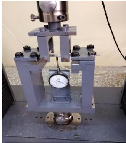
**Figure 2. 9 :** Dispositif utilisé pour le déroulement des essais avec le comparateur de déplacement,
