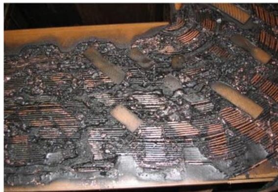
**Figure 5.1** Conséquence du court-circuit entre spires du transformateur de puissance
