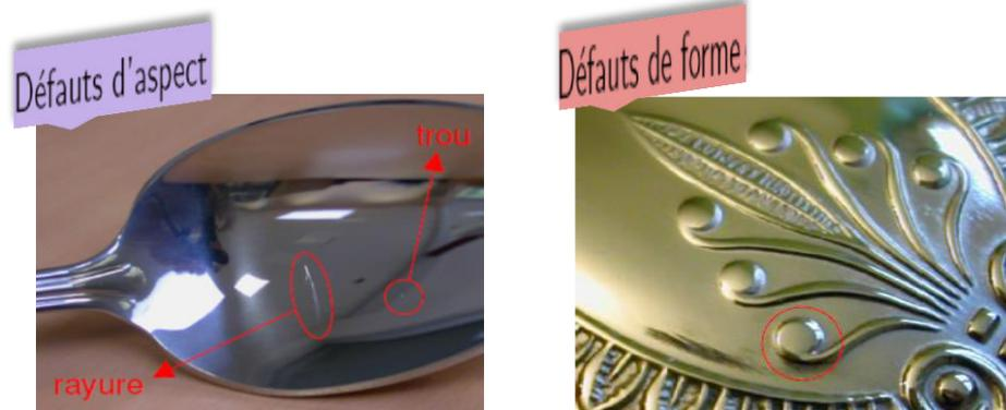
**Figure 2.22.** Différents types de défauts de surface [85]
