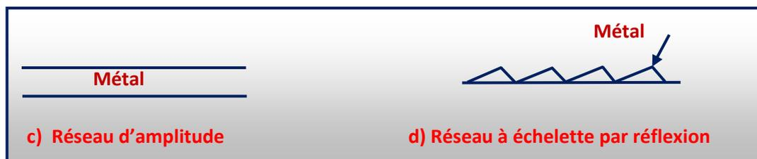
Figure 1.14. Réseau par réflexion
