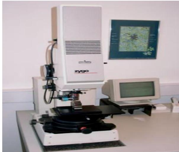
Figure 2.12. Microscope d'interférence ZYGO [62]
