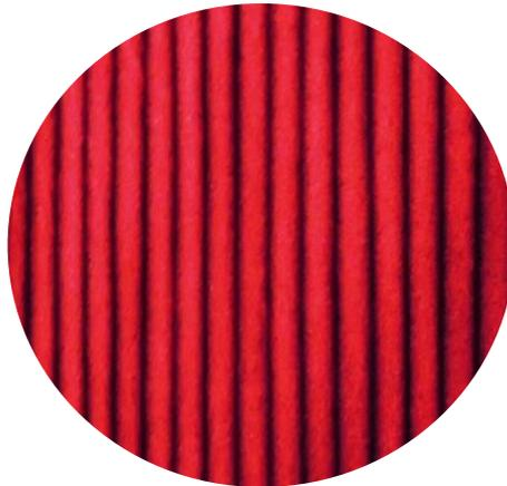
**Figure 3.22.** Franges de moiré de la surface du miroir optique plan
