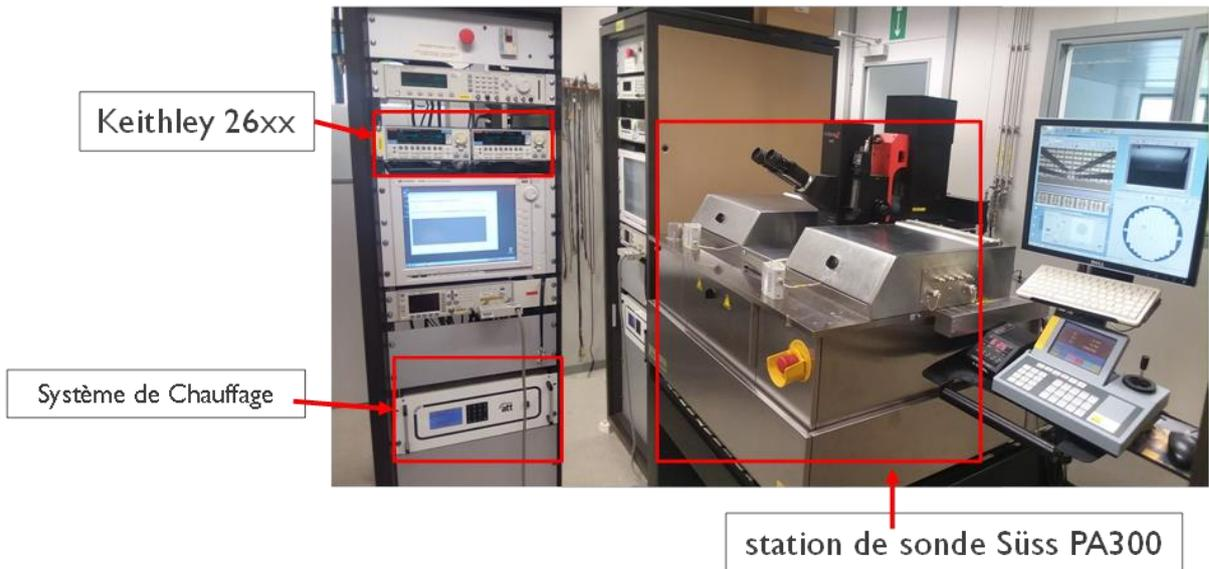
Figure 3.27 : Banc de caractérisation électrique des transistors (labo IMEC ).
