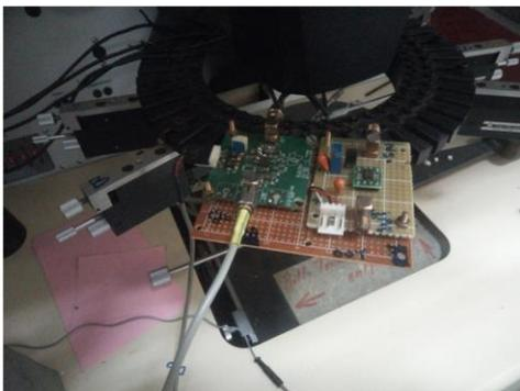
Figures 3.10 : Image de la carte de mesures rapides, à base d'un *OPA* transimpédance, implémentée dans le montage expérimental du *CDTA*.
