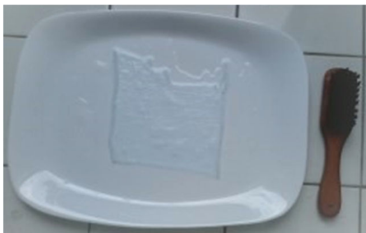
Figure II-18. Lavage du tissu traité suivant la norme AATCC 138-2005 Nettoyage : Lavage des revêtements textiles.
