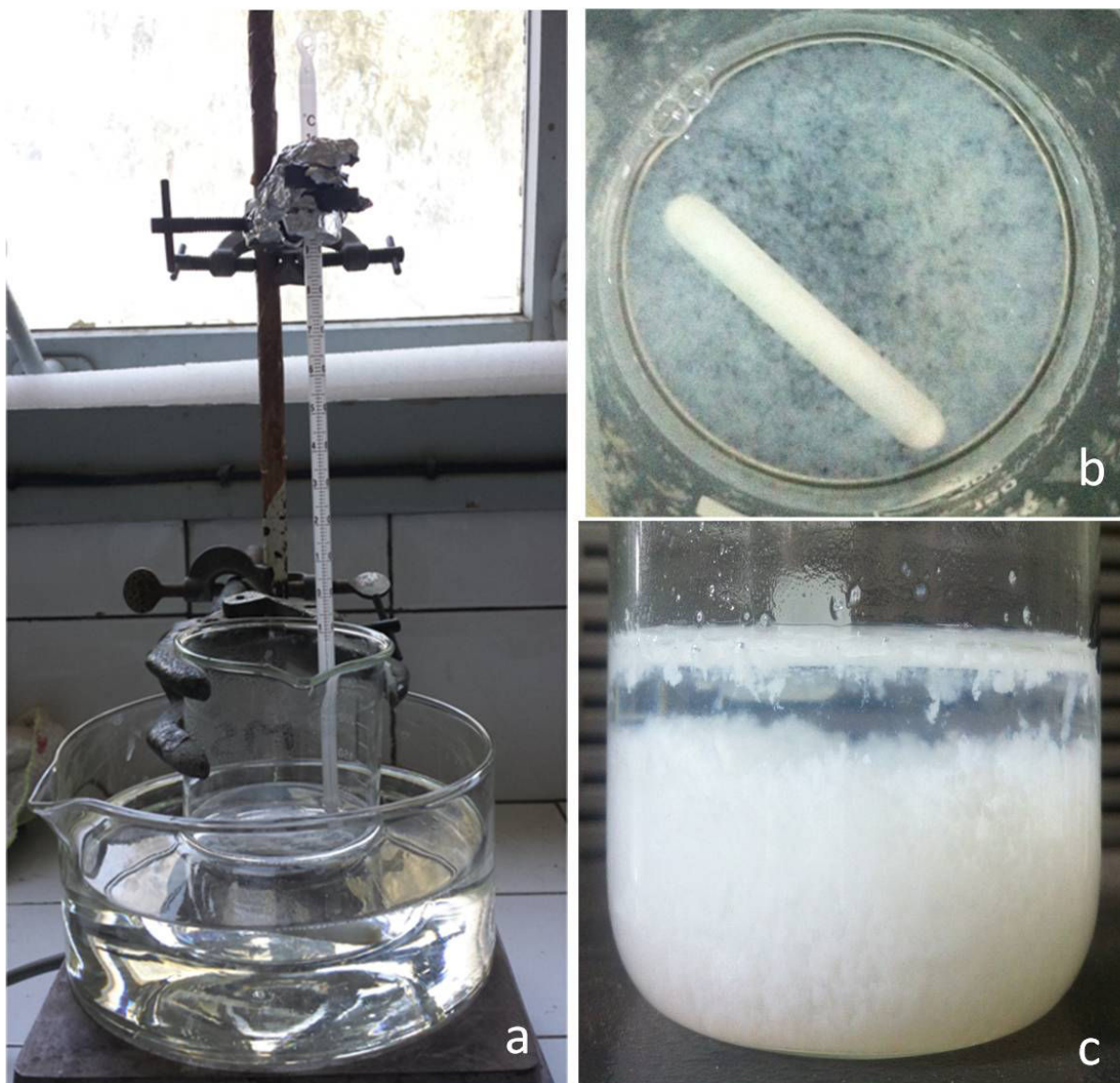
Figure II-6. Le dispositif de la méthode de précipitation (a) et le précipité généré une fois le pH du mélange atteint 10 (b) et (c).
