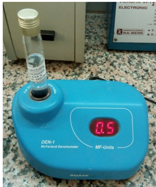
Figure II-11. Une suspension de bactérie à testé diluée à 0,5 McFarland [4].
