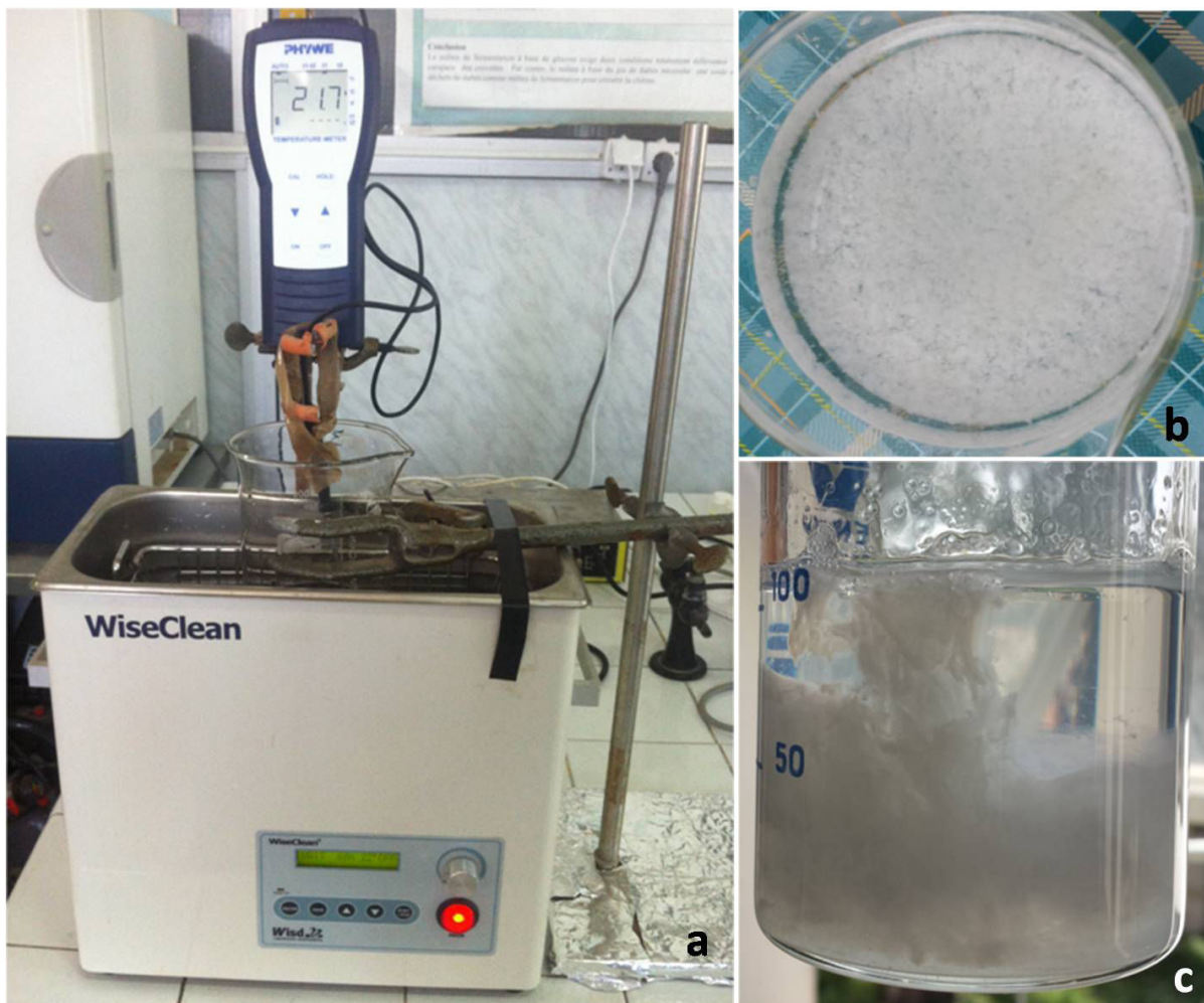
Figure II-7. Le dispositif de la méthode par ultrason (a) et le précipité généré une fois le pH du mélange atteint 10 (b) et (c).
