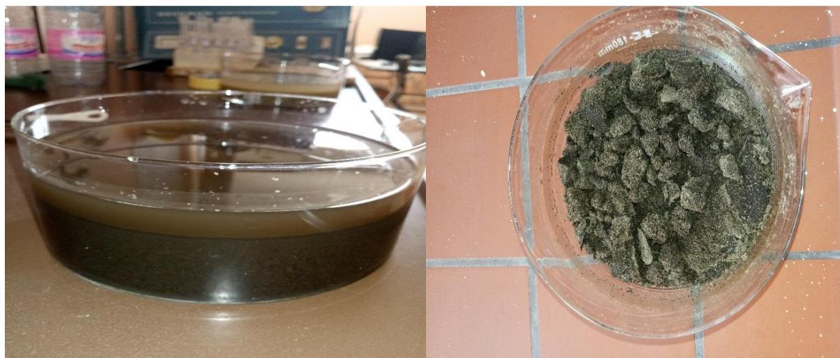
**Figure II.3:** Etapes de préparation du matériau adsorbant des pelures de fèves (PF)
