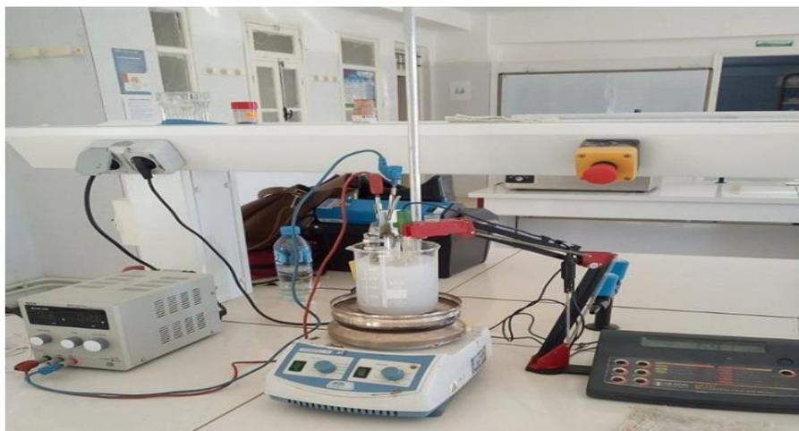
*Figure VII.2: Synthèse électrochimique du phosphate d'aluminium et alumine.*
